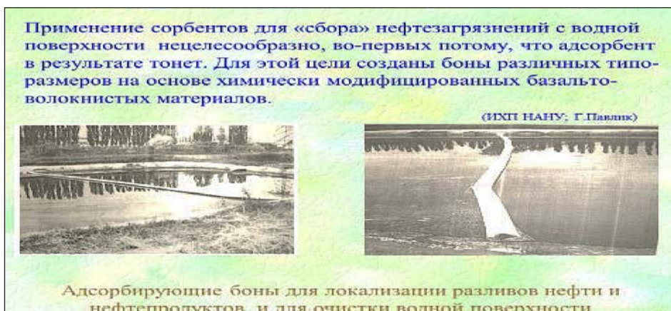
Рис. 3. Базальто-волокнисті бони для локалізації нафтопродуктів на водній поверхні
